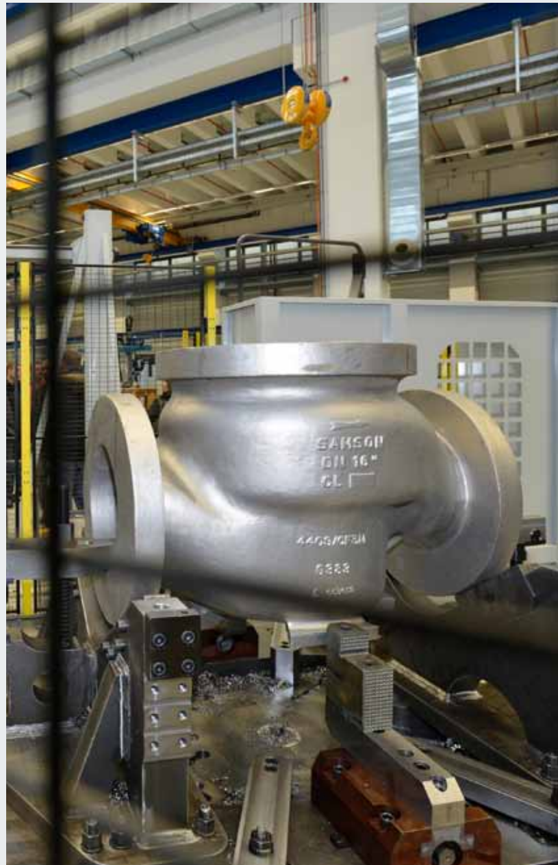
In der neuen Produktionshalle können erstmals direkt auf dem Werksgelände XXL-Ventile bearbeitet und zusammengebaut werden.
