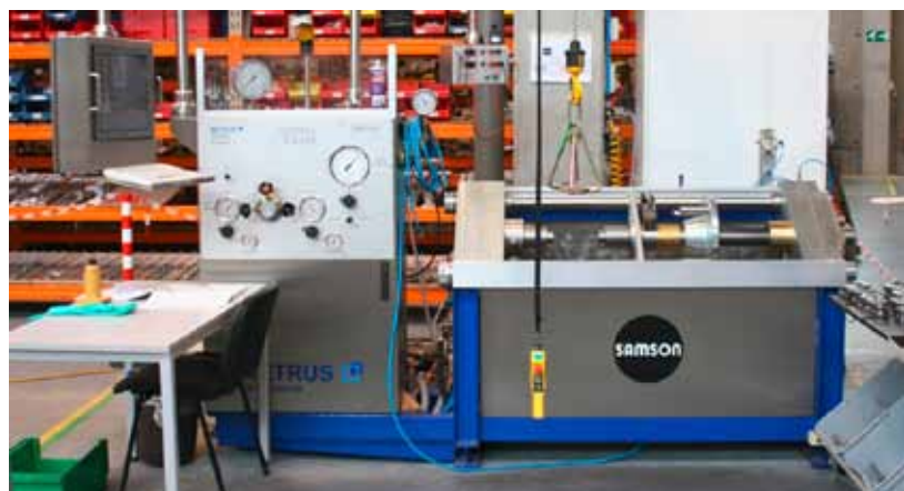
In Antwerpen können komplette Stellventile montiert und auf ihre einwandfreie Funktion geprüft werden.
