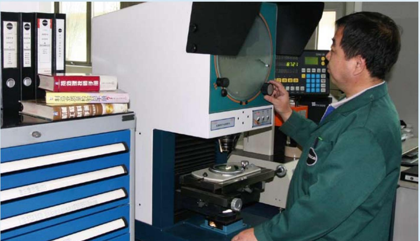
Ein Mitarbeiter der Qualitätssicherung von SAMSON China bei der Prüfung eines Werkstücks
