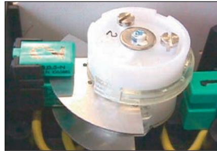
Bild 4: Grenzsignalgeber mit IEC 60947-5-6 konformen Initiatoren
