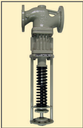
Druckminderer Typ 39 mit Kühlrippen-Zwischenstück für hohe Temperaturen in Dampfleitungen
