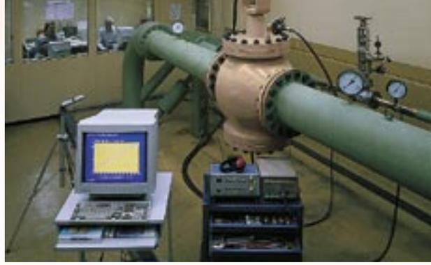
I valori  $x_{Fz}$  di specifica delle valvole vengono determinati su banchi prova, per poter calcolare in anticipo i livelli di erosione e di rumore.
