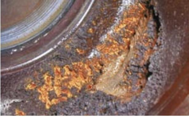
Un corpo valvola eroso da cavitazione intorno al seggio. Continue erosioni di cavitazione causano mancanze esterne di tenuta.
