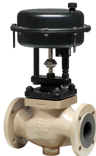
図. 2: アクチュエータ タイプ 3371、操作部面積 350 cm 2 (グローブ弁 タイプ 3321 に取り付け時)
