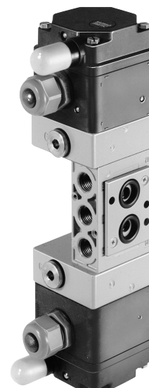
Bild 3: 5/2-Wege-Magnetventil · beidseitig angesteuert · mit zwei rastenden Stellungen · K_{VS} -Wert 1,4 · Anschluss G 1/4, NAMUR
