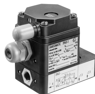
Bild 1: 5/2-Wege-Magnetventil · einseitig angesteuert · mit Feder-rückstellung · K_{VS} -Wert 0,16 · Anschluss G 1/4
