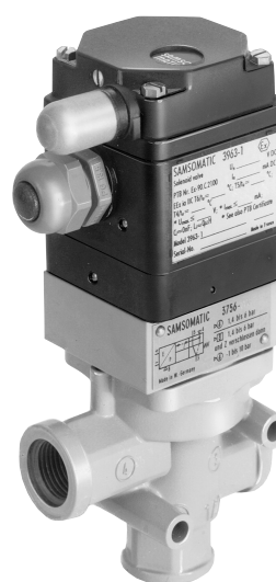
Bild 2: 3/2-Wege-Magnetventil · einseitig angesteuert · mit Federrückstellung · K_{VS} -Wert 4,3 · Anschluss G 1/2
