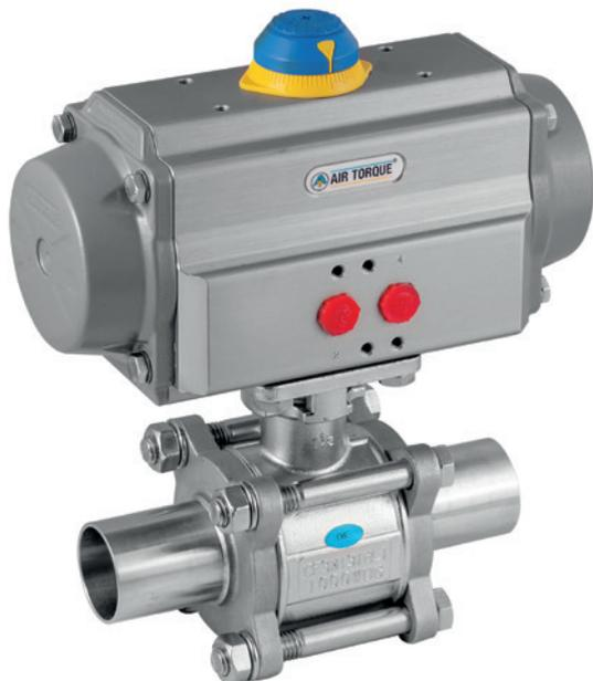
Die Steriflu 342 wird pneumatisch mit einem Kolbenantrieb betrieben, wahlweise einfach oder doppelt wirkend. Der pneumatische Antrieb verfügt über ein extrudiertes Aluminiumgehäuse mit interner und externer Alodur-Spezialharteloxierung zum Korrosionsschutz.
