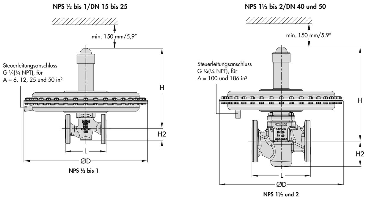
Der Steuerleitungsanschluss ist in der Darstellung um 90° in die Ansichtsebene gedreht. Standardmäßig ist der Anschluss auf der dem Durchflussrichtungspfeil gegenüberliegenden Seite.
