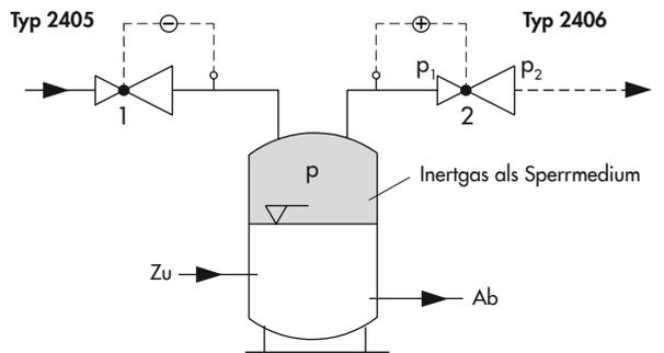
Fällt der Druck  $p$  des Sperrmediums im Behälter unter den eingestellten Sollwert  $p_1$  des Druckminderers **Typ 2405** (1), öffnet dieser und es strömt Gas nach. Steigt der Druck  $p$  des Gaspolsters, schließt der Regler (1). Ist der Druck zu hoch, strömt durch das Überströmventil **Typ 2406** (2) Gas ab.
