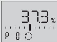
Lorsque l'initialisation est réussie, l'affichage passe au code **P0** et le positionneur passe en fonction régulation identifiée par le symbole
