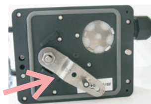
Figura 3 · Fermo di arresto della leva di regolazione
