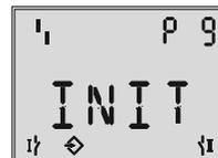
**P9:** Initialisierung wird ausgeführt
