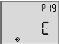
**P19:** Simulation Kontakt C (Signal bei Erreichen des PST-Ziel Fensters beim Teilhubtest)
