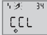
关闭方向 (使阀门移至 CLOSED (关闭) 位置的旋转方向) (在定位器显示屏上查看)；标准 CCL
