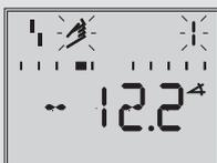
在 tEStinG 横穿显示屏运行之后，定位器尚未初始化时，故障报警图标出现且手图标在显示屏上闪烁。读数用角度指示操纵杆相对于中轴的位置。
