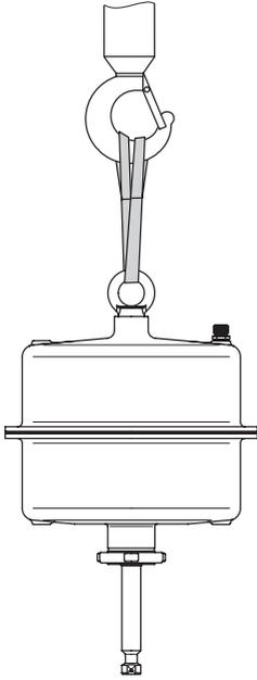
图4-5: 执行机构上的提升点
