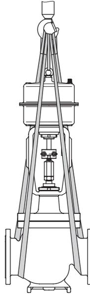
图4-6: 控制阀上的提升点 (示例)
