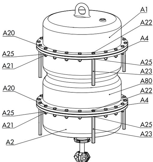
图11-2: 带夹紧螺母和螺栓的串联执行机构
