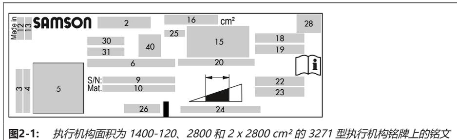
图2-1: 执行机构面积为 1400-120、2800 和 2 x 2800 cm<sup>2</sup> 的 3271 型执行机构铭牌上的铭文
