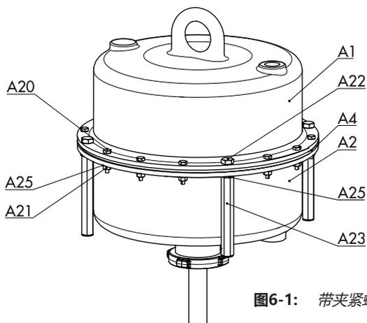
图6-1: 带夹紧螺母和螺栓的单个执行机构
