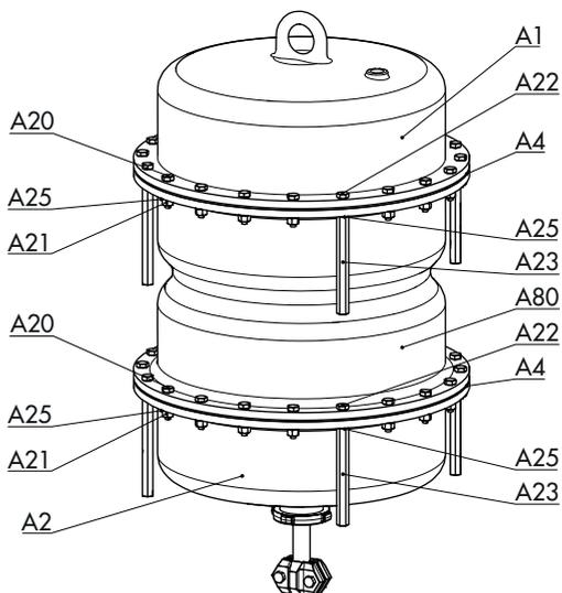
图6-2: 带夹紧螺母和螺栓的串联执行机构
