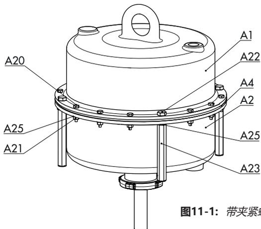
图11-1: 带夹紧螺母和螺栓的单个执行机构
