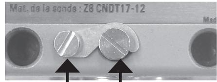
Schraube mit Sicherungsbügel
