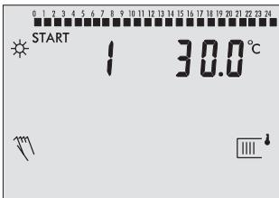
Die Ziffer hinter „START\_“ zeigt an, in welcher Betriebsphase sich die Estrichrocknung befindet:
