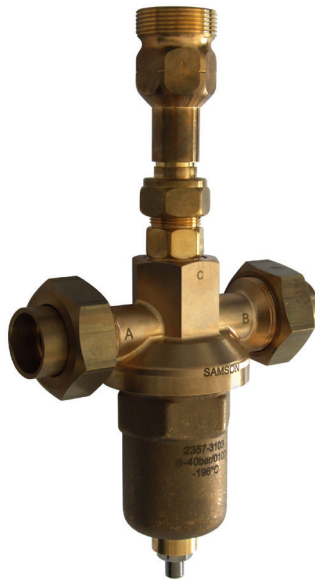
Typ 2357-31 mit Rückschlagseinheit an Anschluss C · Anschlüsse A und B mit Lötnippel und Kugelbuchse
