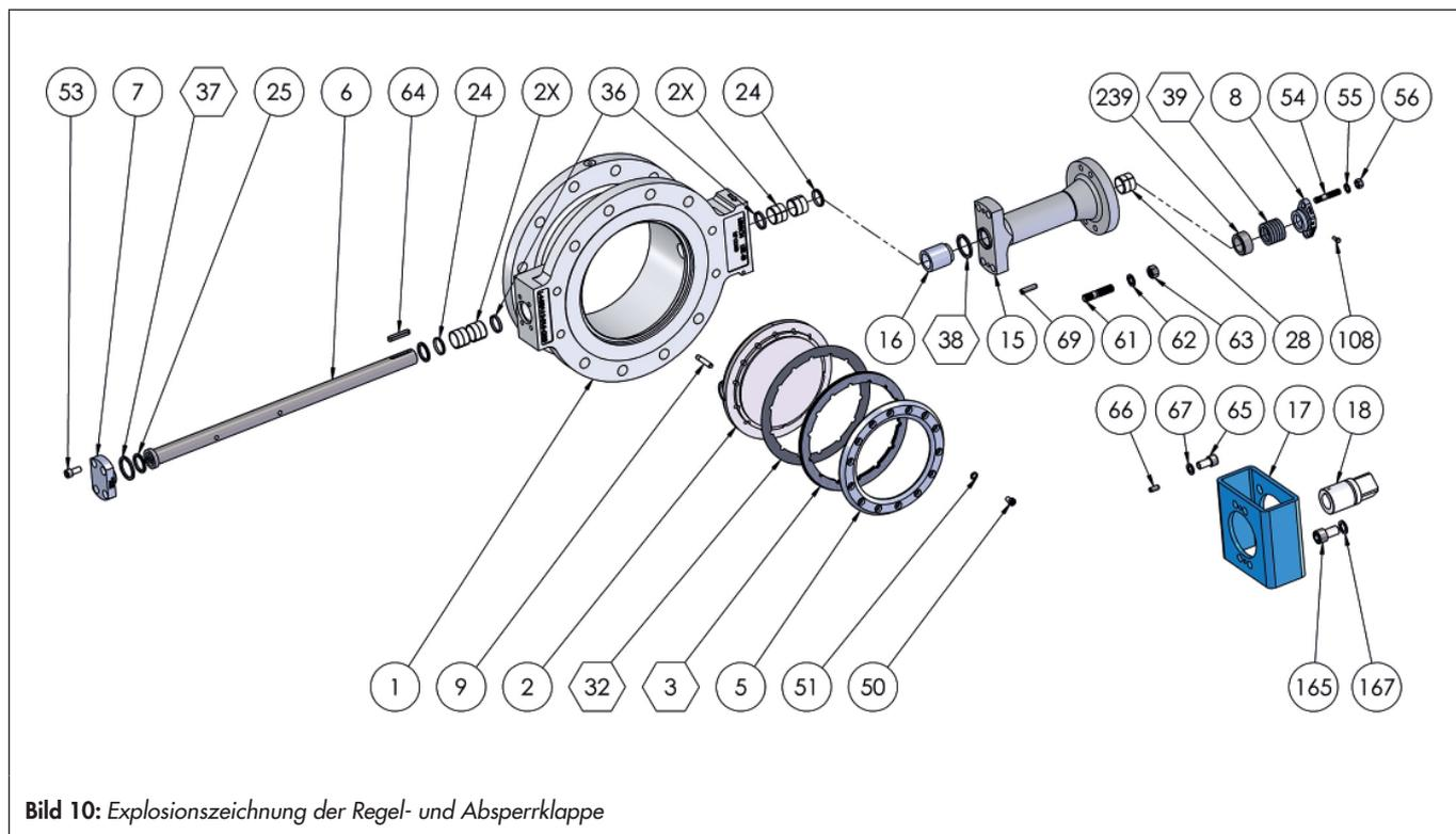
Bild 10: Explosionszeichnung der Regel- und Absperrklappe
