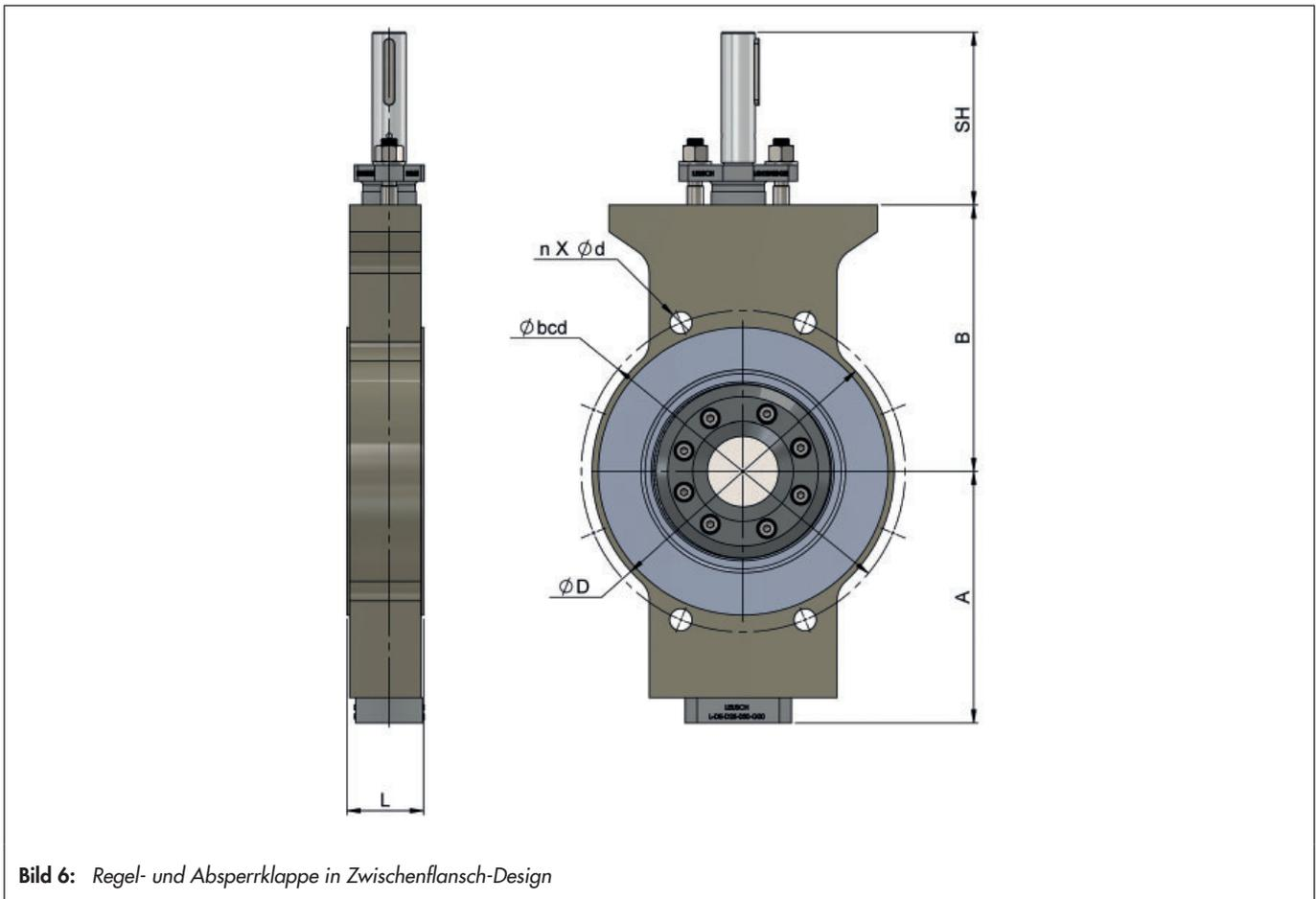
Bild 6: Regel- und Absperrklappe in Zwischenflansch-Design
