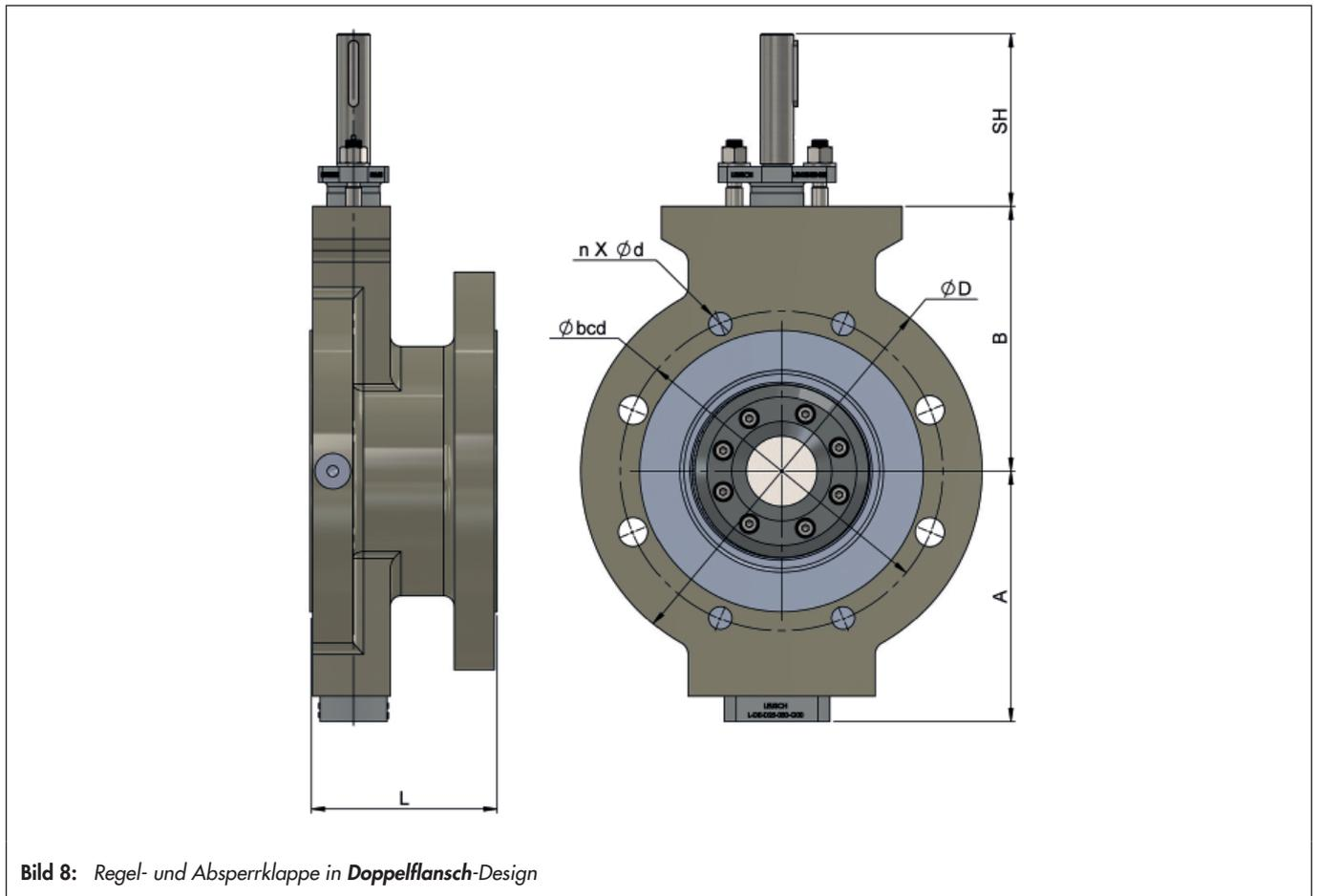
Bild 8: Regel- und Absperrklappe in Doppelflansch-Design
