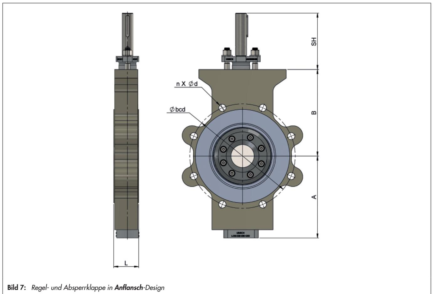
Bild 7: Regel- und Absperrklappe in **Anflansch-Design**
